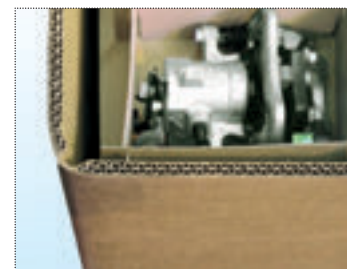
Stěna boxu ze sedmivrstvé vlnité lepenky
